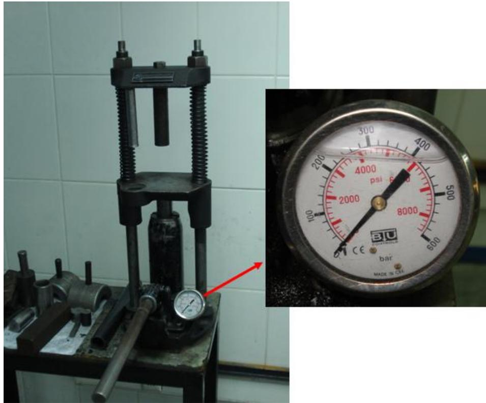
Figura 3.10: Prensa hidraulica Buehler.
