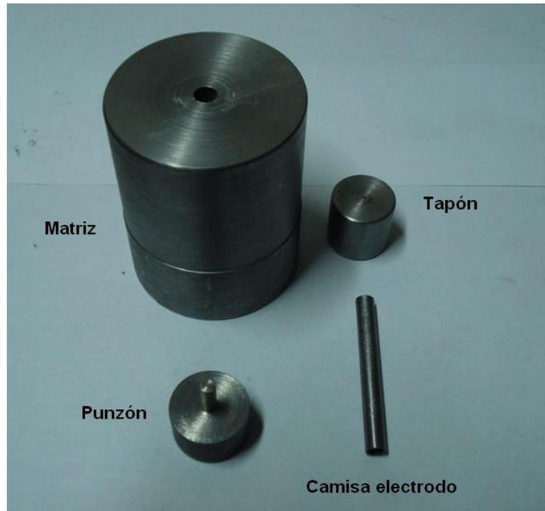
Figura 3.11: Elementos utilizados en el compactación de los polvos metalúrgicos.
