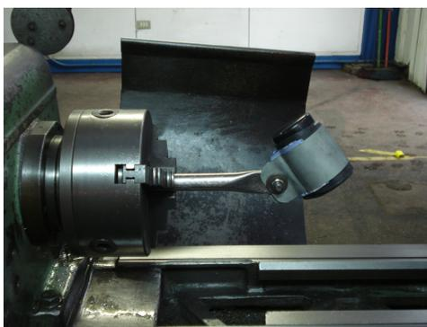
Figura 3.9: Torno mecánico utilizado en la mezcla de polvos metalúrgicos.
