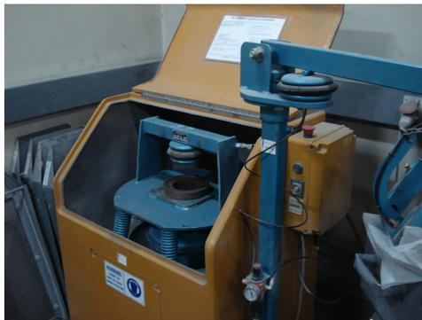
Figura 3.8: Pulverizador Labtechnics.
