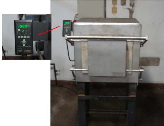
Figura 3.12: Horno eléctrico utilizado en la sinterización.
