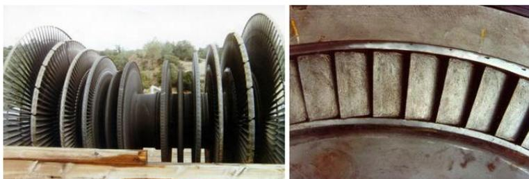
Figura 2.2: Depósito de  $Cr_3C_2$  en zonas del rotor de la turbina y de WC en los álabes.
