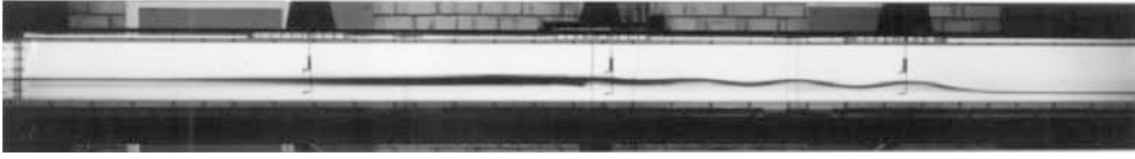
Figura 2.5: Muestra un paquete de ondas internas solitarias generadas a nivel experimental en un flujo estratificado (Horn et al. , 2001). Es posible observar el frente vertical de la primera onda, y el proceso de degeneración llevado a cabo.
