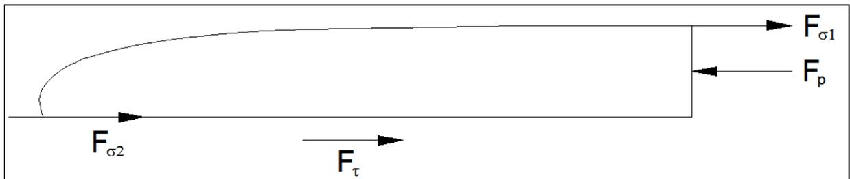
**Figura 5.3: Esquema de fuerzas sobre el fluido**
