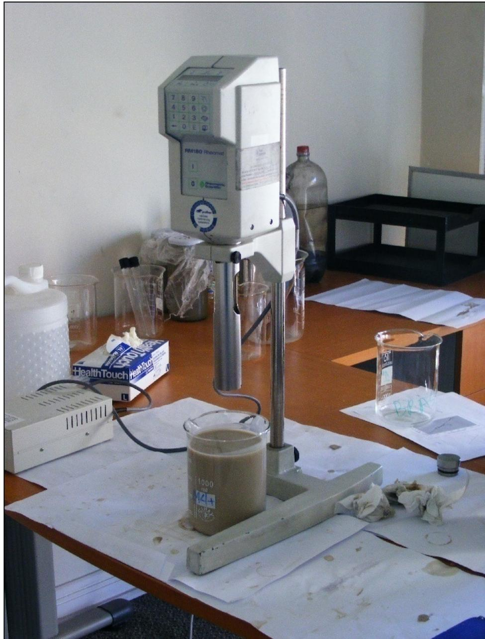
Figura 6.1: Reómetro Rheomat RM-180
