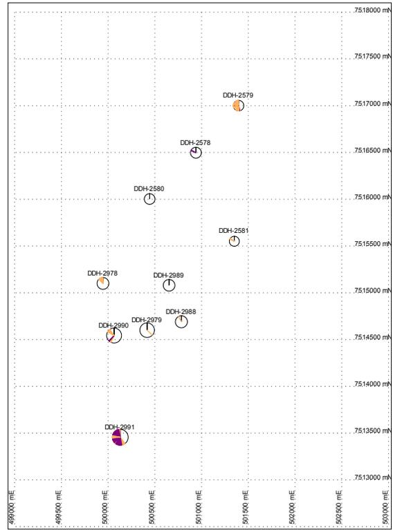
**Fig. 27:** Distribución de Vetillas C: Vetillas BC (color morado), ocurren principalmente en sector sur del Proyecto, mientras que las vetillas “CD” (color mostaza) se encuentran ampliamente distribuidas.
