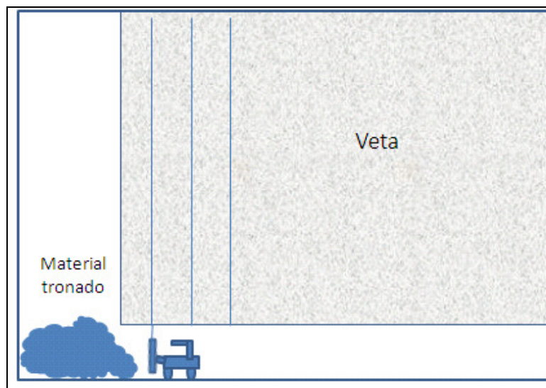
Figura 5: Esquema de producción de Uphole retreat.
