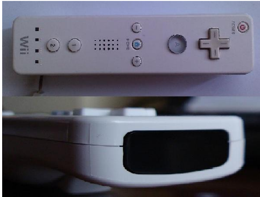
Figura 3.2: (Arriba) Vista superior del Wiimote. (Abajo) Vista frontal con cámara infrarroja del Wiimote en primer plano.
