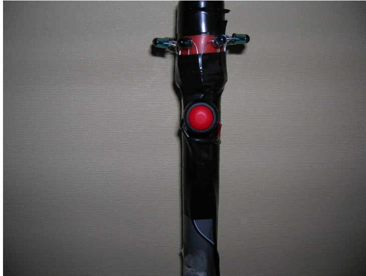
Figura 4.5: Vista lateral de la adaptación realizada al bastón. Se observa el switch de color rojo que permite al usuario enviar su posición al sistema cuando este lo requiera.
