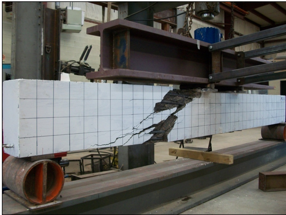
Figura 4.8: Falla de la viga PCD3 ( a/d = 4.5 ).
