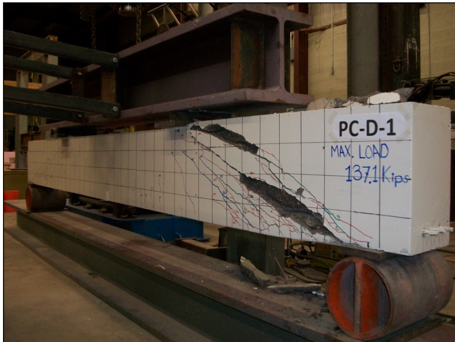
Figura 4.6: Falla de la viga PCD1 ( a/d = 3 ).
