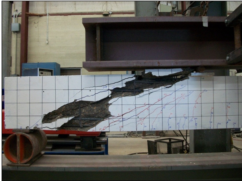
Figura 4.7: Falla de la viga PCD2 ( a/d = 4 ).
