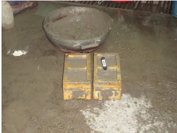
Figura 5.3. Probetas utilizadas para inicio y termino de fraguado.
