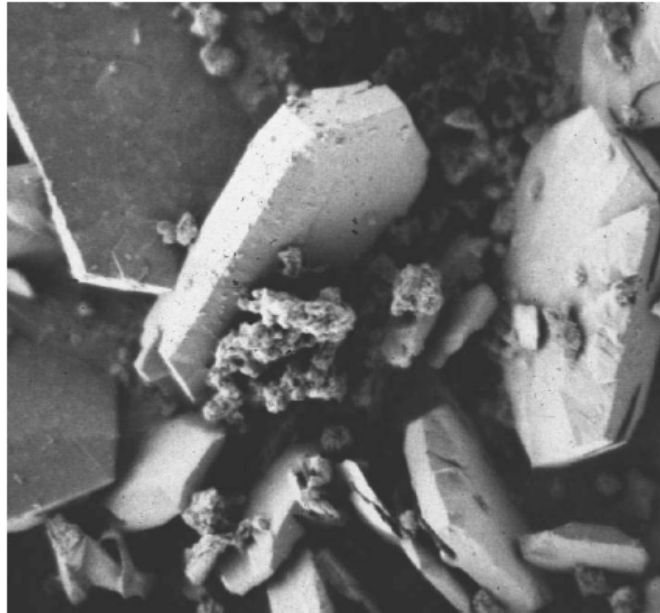
Figura N° 2.2. Fotografía de unos cristales de hidróxido de calcio.
