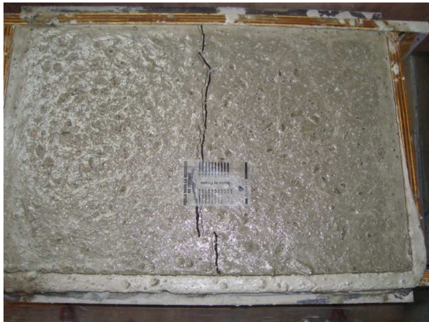
Figura Nº 6.2. Otra fotografía de ensayos que presenta el patrón característico de fisuración de las probetas.
