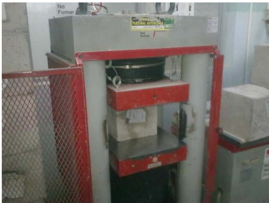
Figura 5.4. Ensayo de resistencia a la compresión de probetas de hormigón.
