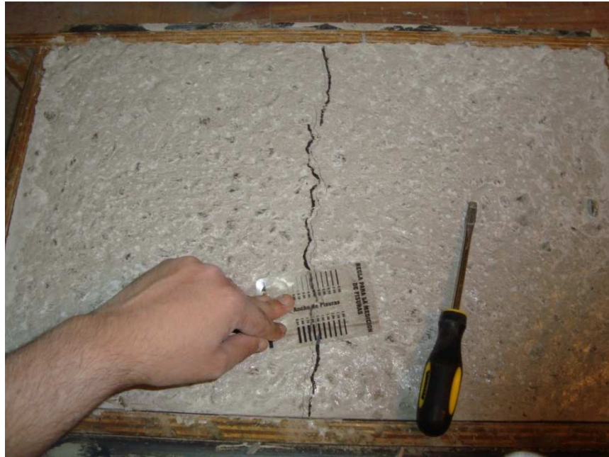
Figura Nº 6.1. Fotografía correspondiente a una fisura típica, resultado de los ensayos
