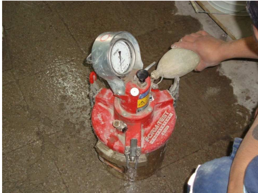
Figura 5.2. Ensayos de densidad aparente y contenido de aire en el hormigón.
