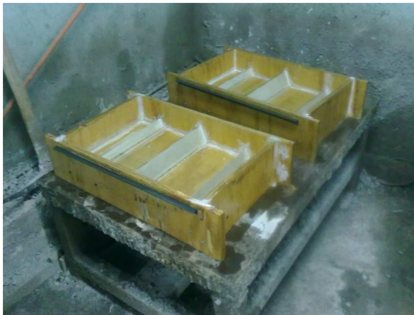
Figura Nº 3.2. Moldes para el ensayo de fisuración
