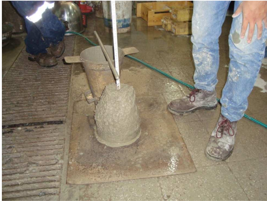
Figura 5.1. Ensayo de asentamiento de cono de Abrams.
