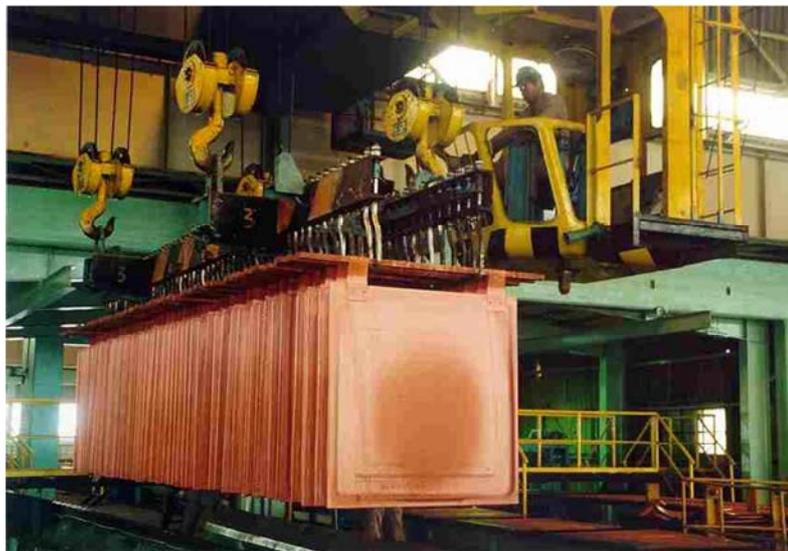
Imagen 1.2 - Cátodos de cobre recién cosechados desde las celdas
