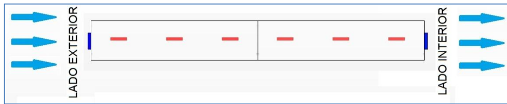
Fig. 4.4: Vista Lateral de dos cajas donde los cuadrados rojos representan sensores de pulpa y los azules representan sensores de Tº ambiente.
