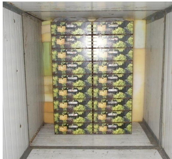
Figura 4.17: Arreglo de cajas posicionado dentro del túnel con sus contornos sellados
