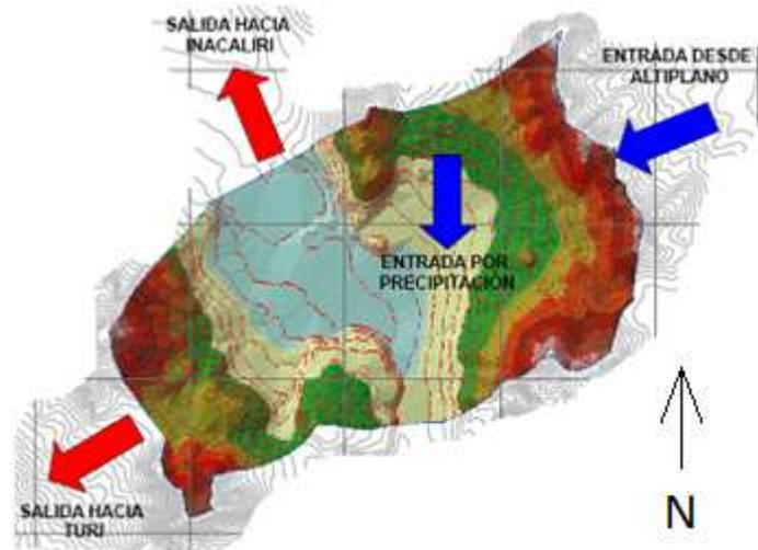
Figura 1.2 Esquema del balance hidrológico sistema Pampa Peineta.
