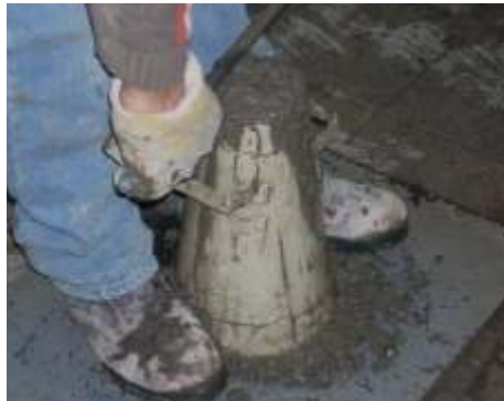
Figura 4.2. Ensayo asentamiento de cono de Abrams
