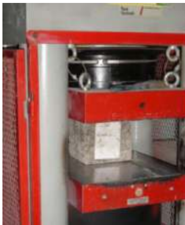
Figura 4.5. Ensayo resistencia a la compresión
