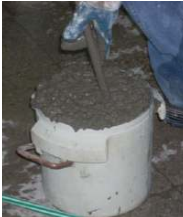
Figura 4.3. Ensayo de densidad
