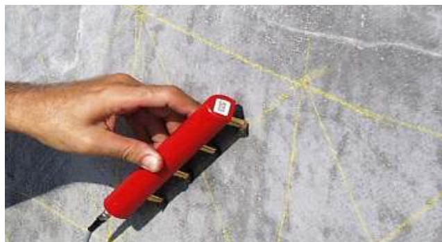
Figura 1.1: Mediciones de resistividad in-situ utilizando el Método de Wenner.
