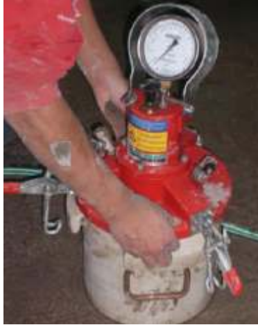
Figura 4.4. Ensayo contenido de aire.
