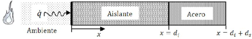
Figura 2.9: Esquema unidimensional de un perfil de acero protegido con material aislante.
