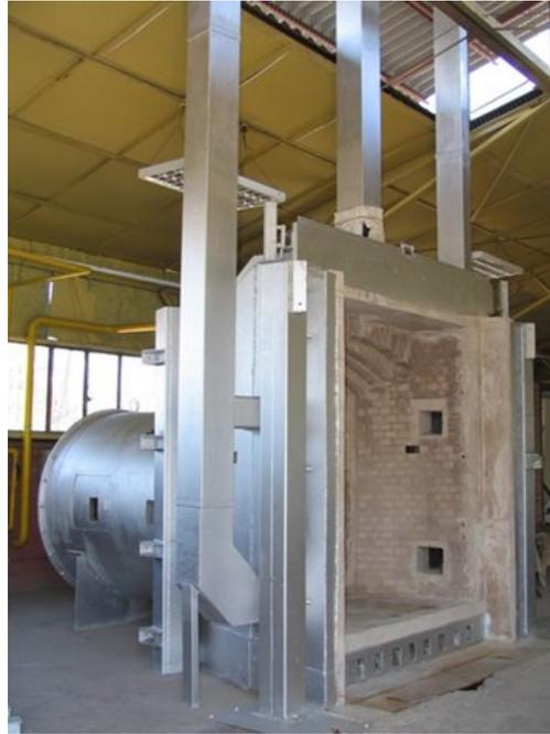
Figura 2.6: Horno de ensayo del IDIEM de la Universidad de Chile.
