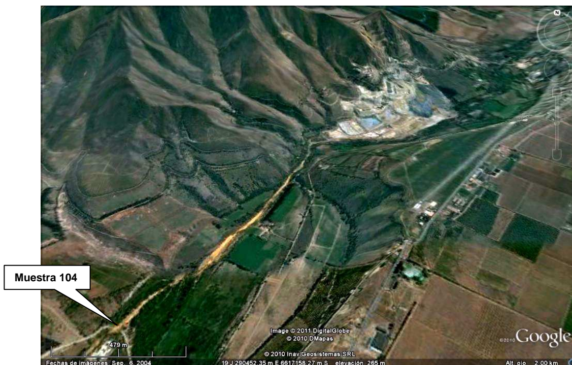
Figura 5.4: Imagen satelital (imagen Google Earth orientada hacia el norte) de la planta La Cocinera. Se observa que las aguas del Estero Ingenio adquieren un color anaranjado aguas abajo de la planta, fenómeno probablemente asociado a de los drenajes de esta. Estas aguas riegan posteriormente un sector agrícola. La muestra 104 fue recolectada en este sector.
