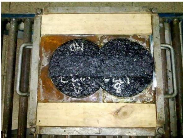
**Figura 23: Probeta confeccionada por vibrado ensayada en Aire.**
