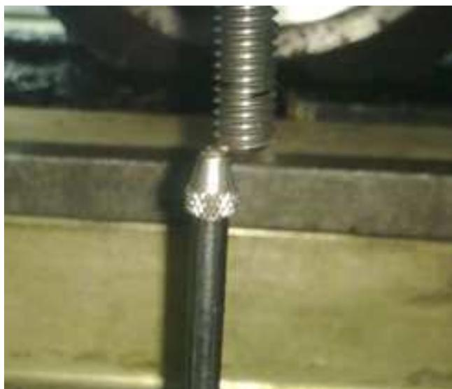
Figura 71: Pérdida del contacto entre el tornillo solidario con la rueda y el micrómetro.
