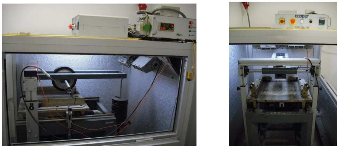
Figura 5: Máquina para ensayo de Pista de Laboratorio
