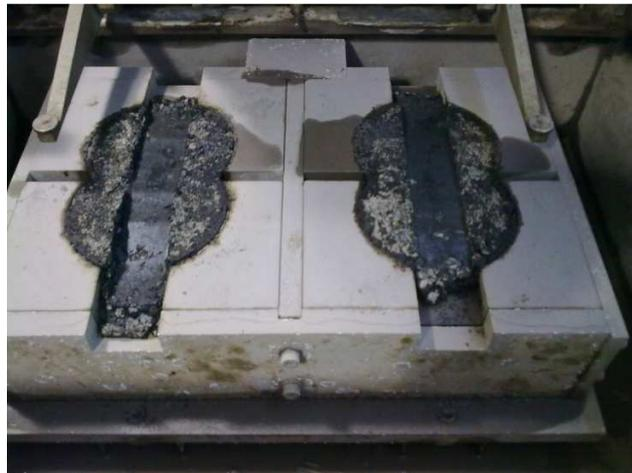
Figura 25: Probetas luego de ser ensayadas en Máquina Hamburgo.
