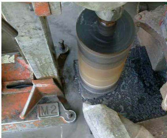
**Figura 16: Extracción testigo para ensayar en máquina de Hamburgo.**
