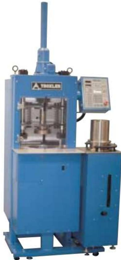
Figura 19: Compactador giratorio y gato para desmolde.
