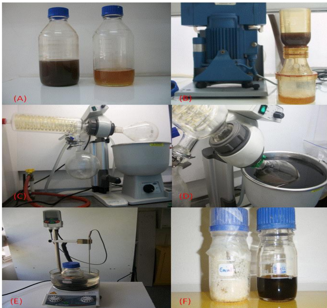
Ilustración D.1. Recuperación de L.I. (A) A la izquierda se observa la solución "L.I.-Agua" luego del lavado de material lignocelulósico y a la derecha, luego de ser filtrado. (B) Solución en el proceso de filtrado con papel filtro. (C) Rotovapor para primera etapa de destilación. (D) Baño de glicerol a 150°C con una solución "L.I.-Agua" filtrada. (E) Baño en aceite siliconado para segunda etapa de destilación. (F) A la izquierda Líquido iónico puro (sales blancas) y a la derecha, L.I. reciclado (licor negro).
