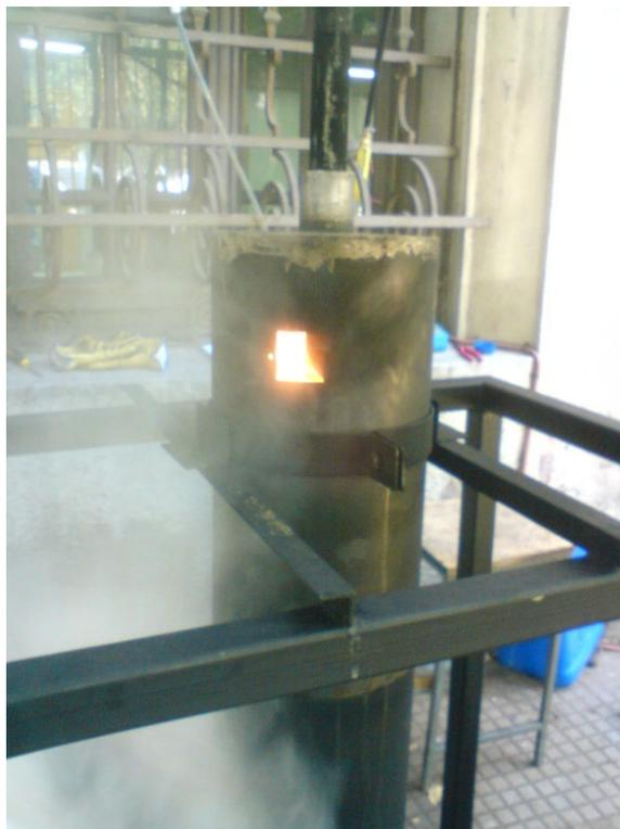
**Figura 26: Llama encendida por un corto periodo de tiempo dentro del tubo y con la punta del quemador a 70[cm] de la parte final del tubo.**
