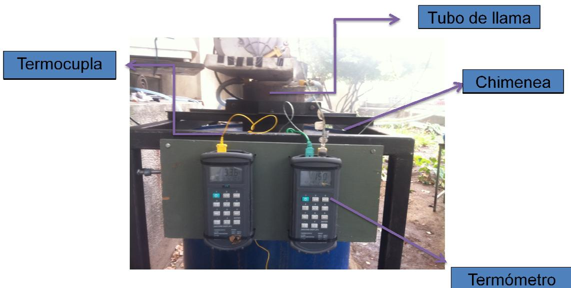
Figura 12: Calentador de agua, construcción final, vista lateral.
