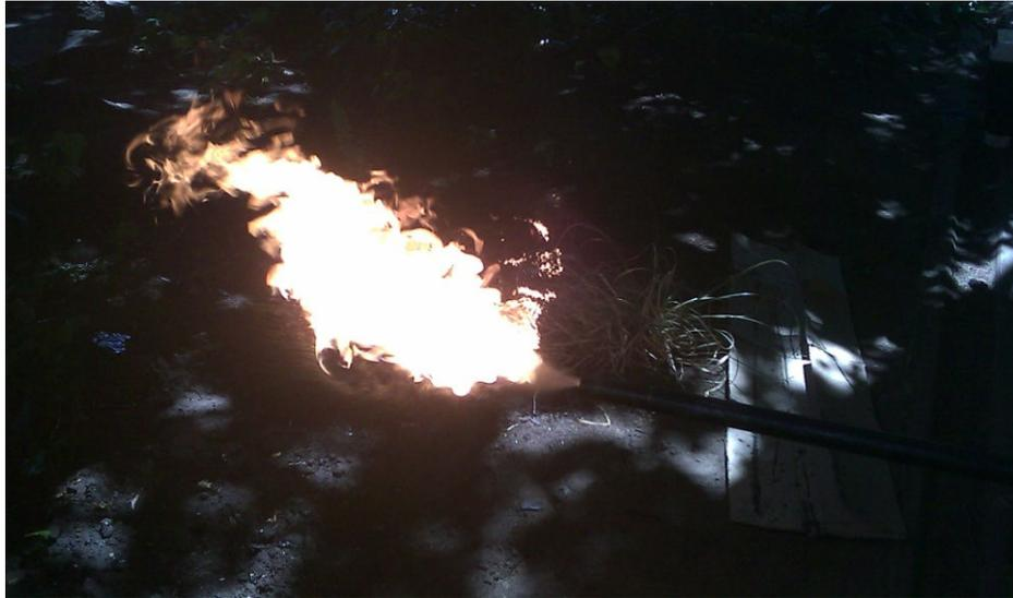
**Figura 27: Llama encendida en forma horizontal sin tubo de llama, donde se puede apreciar la atomización del combustible.**
