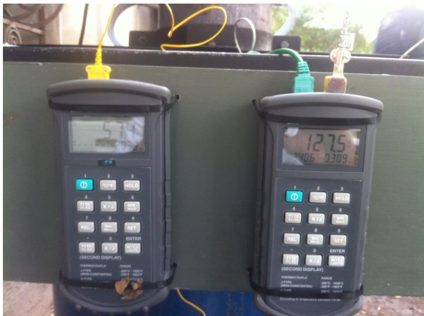
Figura 30: Termocuplas conectadas a los termómetros registrando datos en pruebas preliminares.
