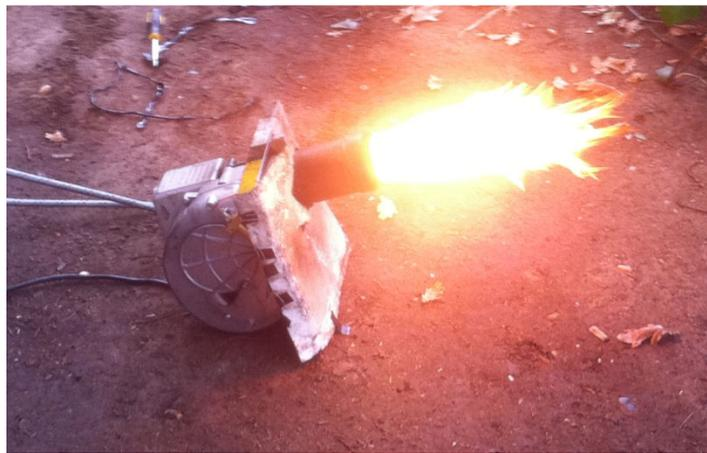
**Figura 15: Quemador RIELLO encendido**
