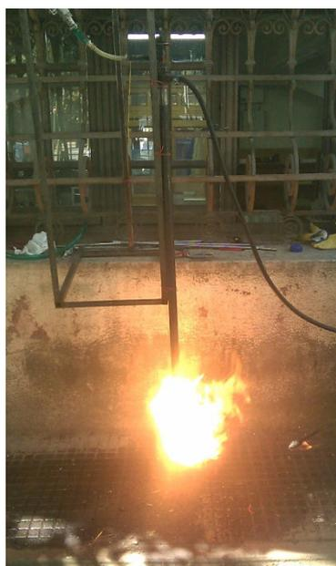
**Figura 14: Quemador en orientación horizontal**
