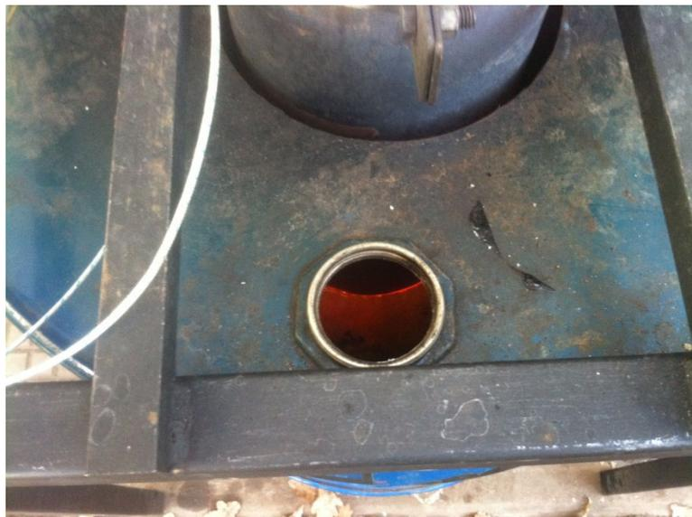
**Figura 28: Llama sumergida dentro del calentador, se pueden apreciar impurezas en el líquido**
