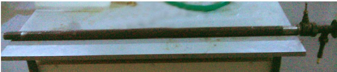
**Figura 8: Quemador Diesel que utilizaba un fluido auxiliar para la atomización**
