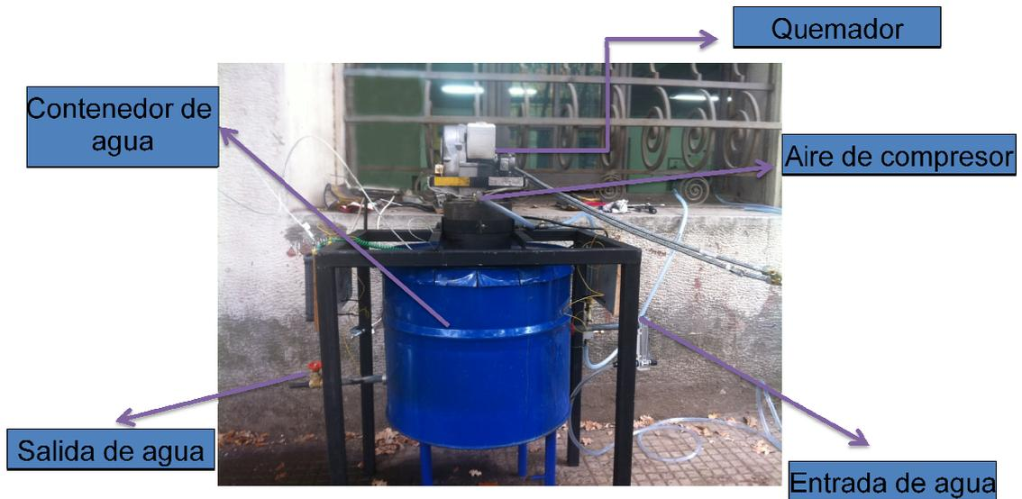
Figura 11: Calentador de agua, construcción final, vista frontal.
