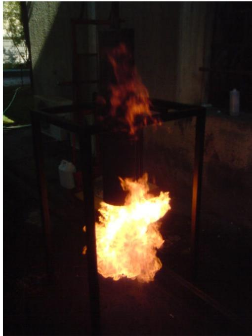
**Figura 25: Llama encendida por un 1 minuto dentro del tubo y con la punta del quemador a 5[cm] de la parte final del tubo.**
