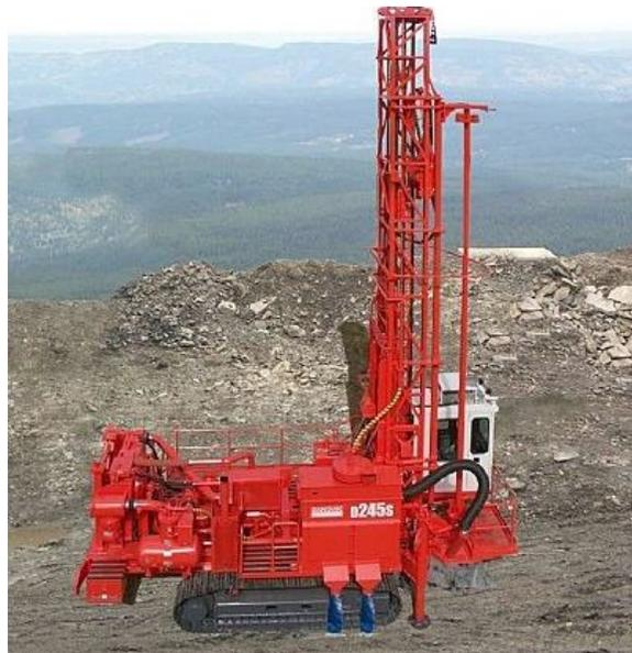
Figura D.9: Perforadoras para agujeros de dinamitado
