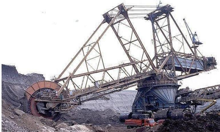
Figura D.6: Excavadoras de rueda o cadena de cangilones
