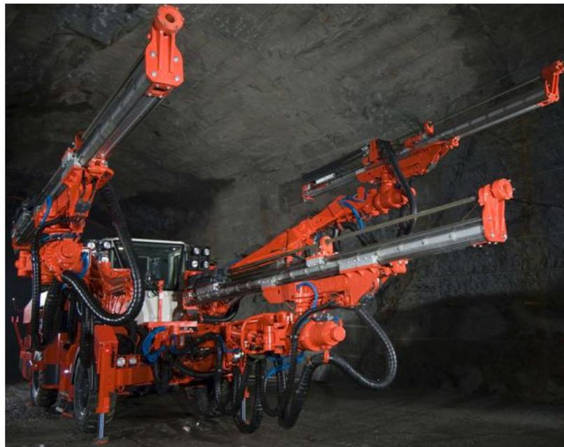
Figura D.13: Perforadora jumbo
