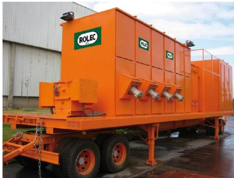
Figura 2.22: Subestación portátil
