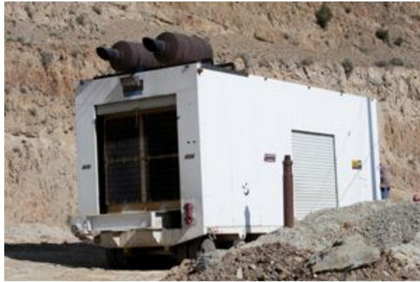
**Figura 2.23: Generador eléctrico diesel portátil**
