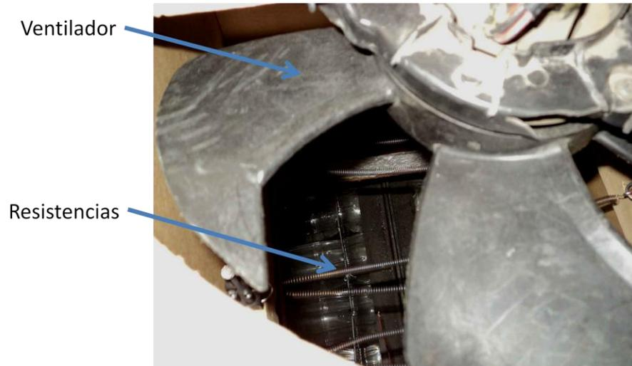
Figura 9-4: Detalle de instalación de ventilador y resistencias en el calefactor.
