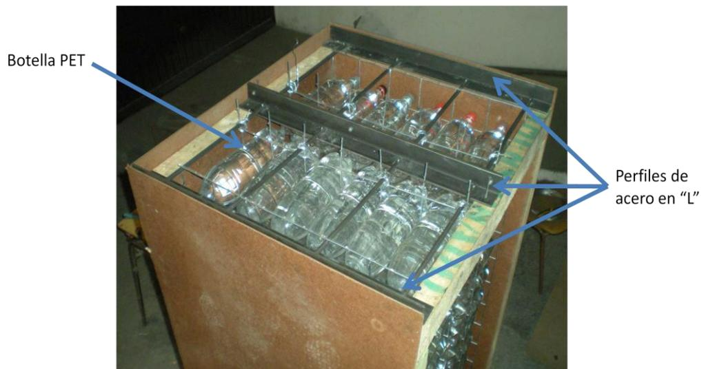
Figura 8-2: Detalle de la apertura superior del acumulador construido. Se encuentra sin las tapas lateral y superior.
