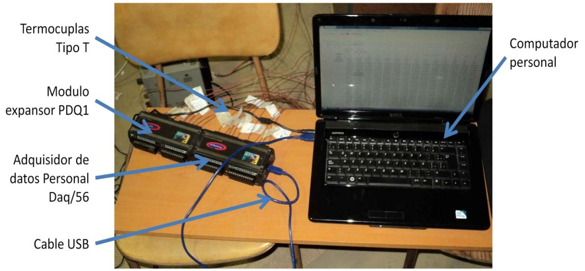
Figura 9-7: Sistema de adquisición de datos.
