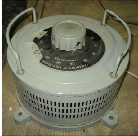
Figura 9-6: Variac utilizado para alimentar el banco de resistencias del sistema calefactor.
