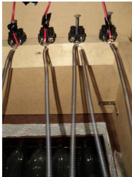
Figura 9-5: Detalle de banco de resistencias al interior del calefactor.
