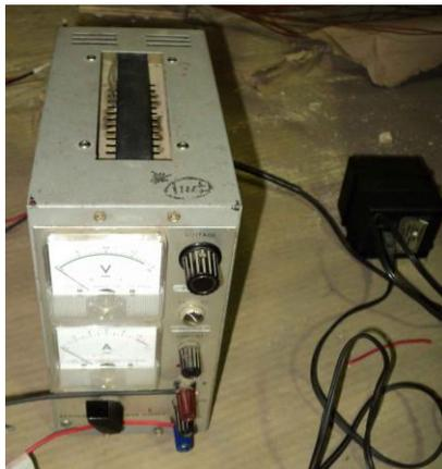
Figura 9-3: Fuente de corriente continua utilizada para alimentar el ventilador del calefactor.
