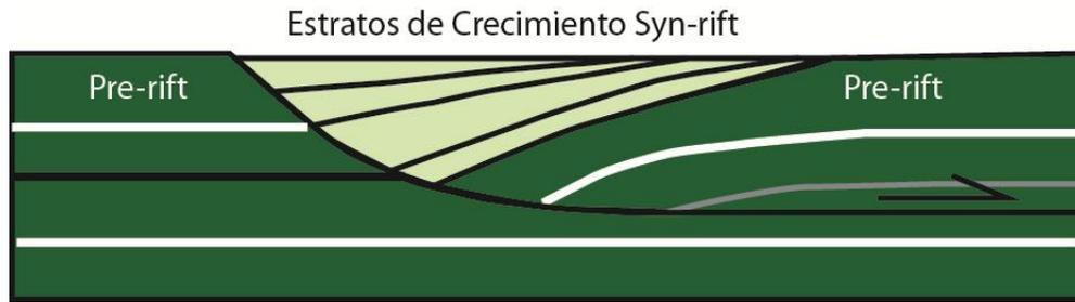
Figura 52: Figura esquemática de la deposición de estratos de crecimiento syn-rift en una falla lítrica, modificado de Withjack, 2006.
