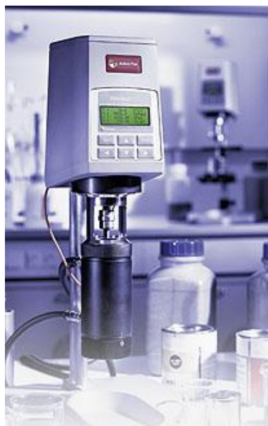
Figura 3.2: Reómetro utilizado para la determinación de la reología de las soluciones de CMC.
