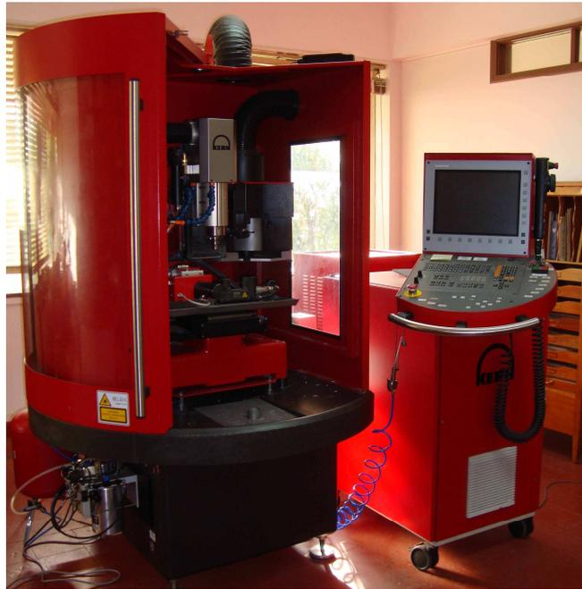
**Figura 9:** Fresadora controlada numéricamente por computadora usada en las instalaciones del Laboratorio de Ondas Milimétricas ubicado en Cerro Calan, Santiago de Chile [35].
