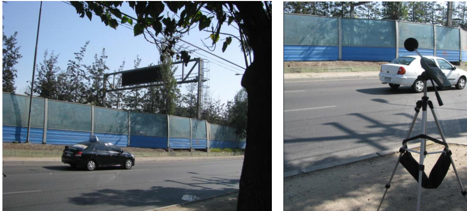
Figura n° 30: Toma de datos en Autopista Central con sistema de barreras.
