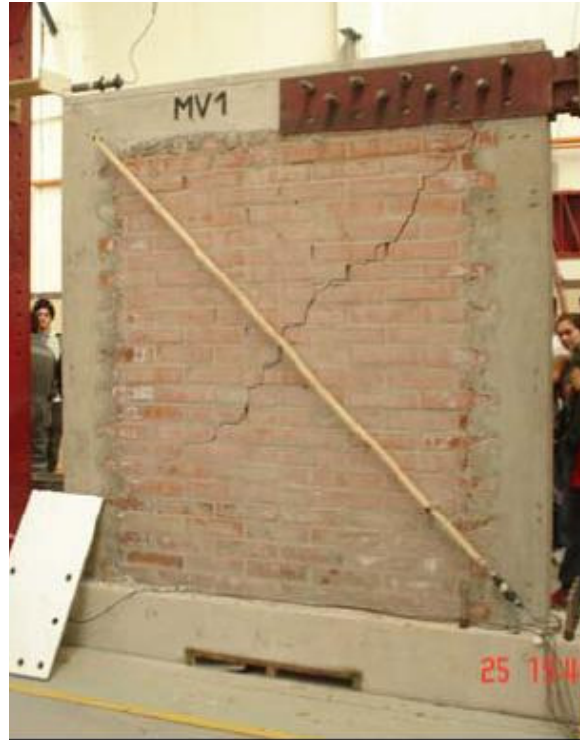
Figura E.34 Estado final de muro MV1 (Galleguillos y Valenzuela, 2009)
