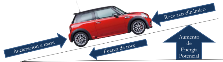
Figura 2.8. Diagrama de fuerzas involucrados en el movimiento de un vehículo.
