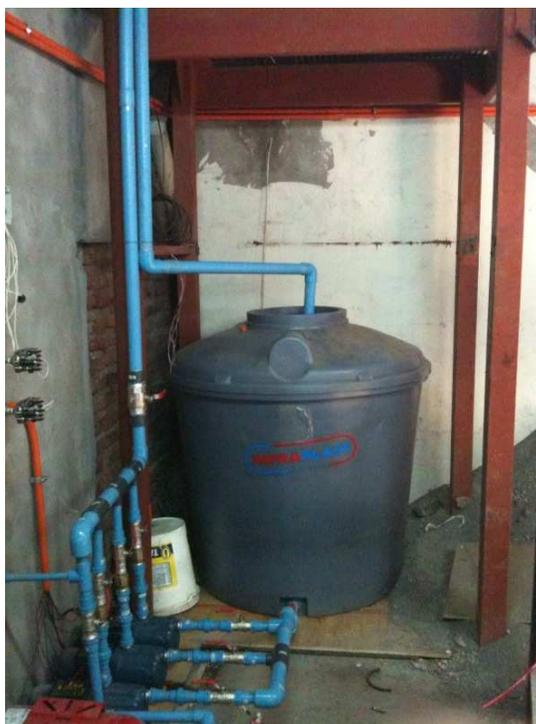
**Ilustración 34. Aspiración e impulsión banco de pruebas.**
