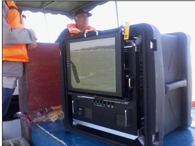
Figura 3.3 Computador a bordo para lectura en tiempo real
