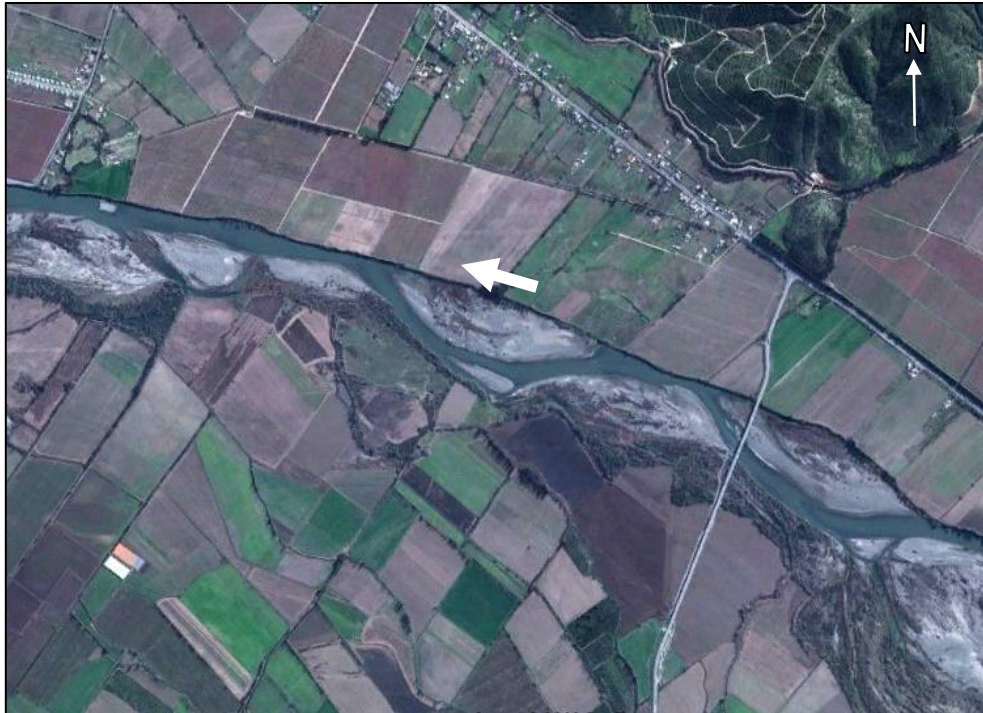
Figura 2.7 Imagen del río Cachapoal en el sector de Puente Arqueado. Se observa la presencia de barras alternadas.
