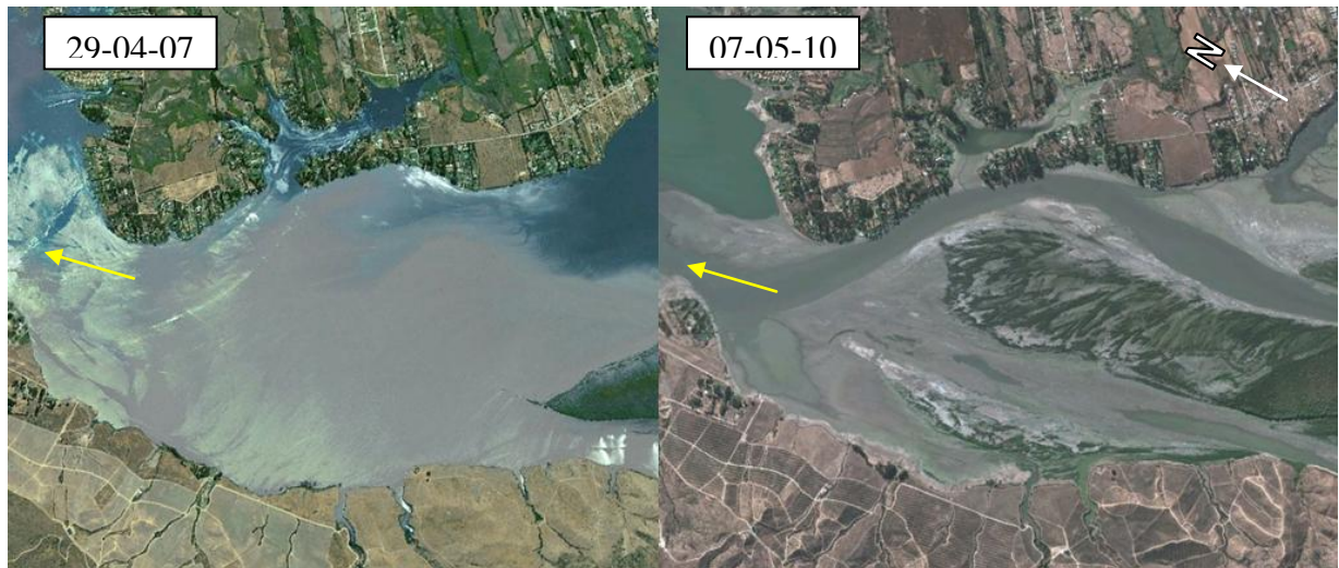
Figura 7.1 Para dos condiciones de caudal distintas, el escurrimiento ocurre por una sección de 2 km o 200 m
