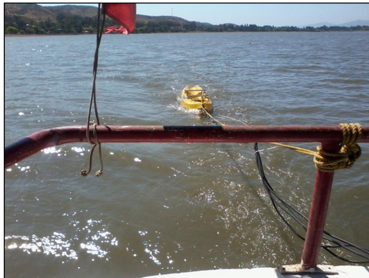
Figura 3.2 Sistema de flotación del equipo BATHY
