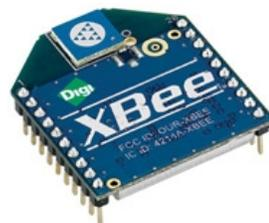
Figura 2.2: Radio XBee con antena integrada.
