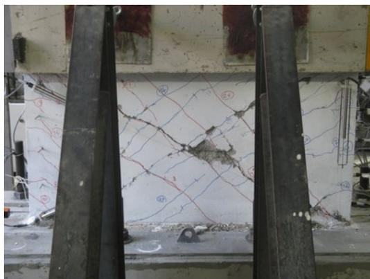
**Figura 4.2:** Espécimen S1, falla por tracción diagonal (Deriva 1,40%)
