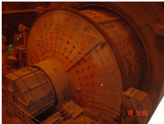
Figura 2.1: Molino SAG de 11 metros de diámetro por 4.6 metros de largo (Planta SAG, Codelco División Andina) [1]
