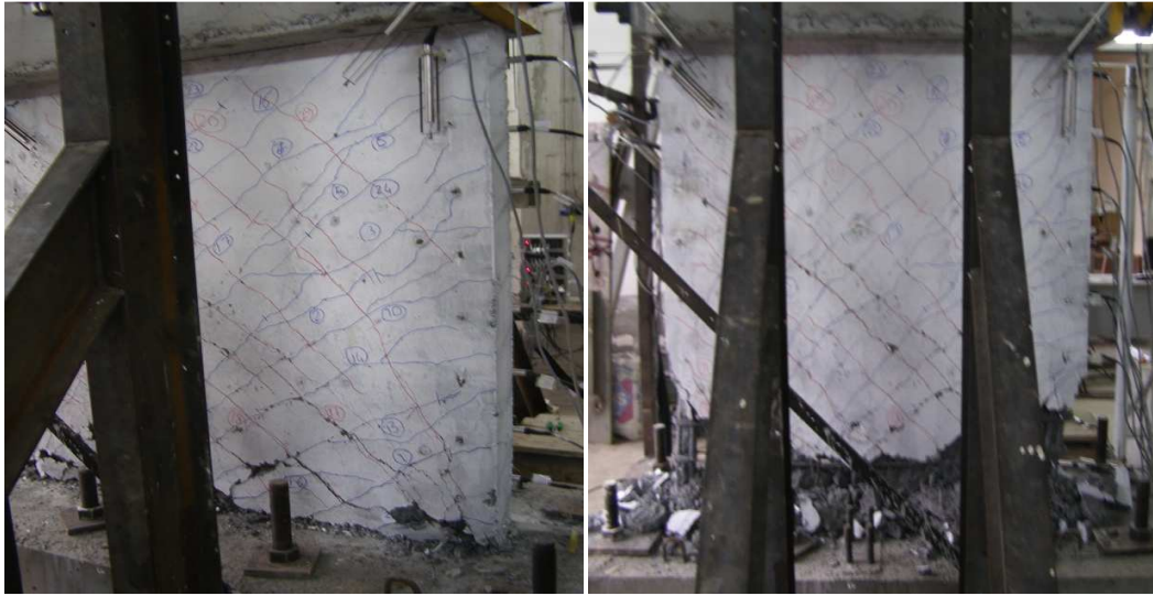
Figura 4.3 Nivel de daño moderado y severo en muro SW-T6-S1-8 (Terzioğlu, 2011).
