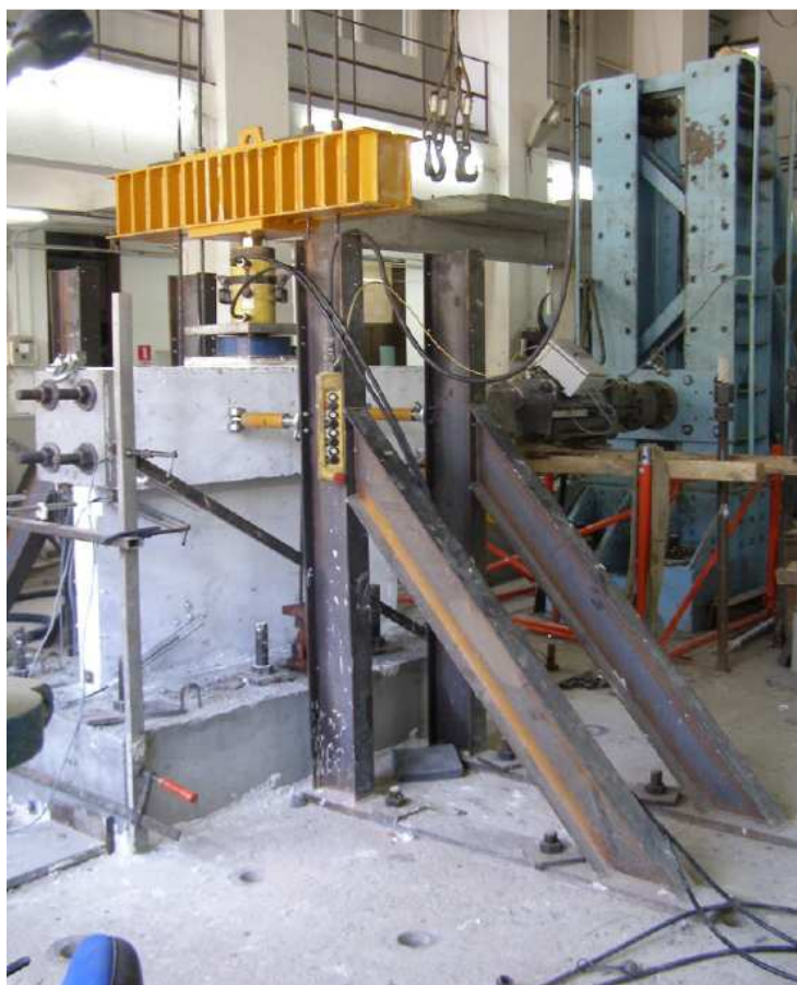
Figura 3.7 Configuración para aplicación de carga axial (Terzioğlu, 2011).
