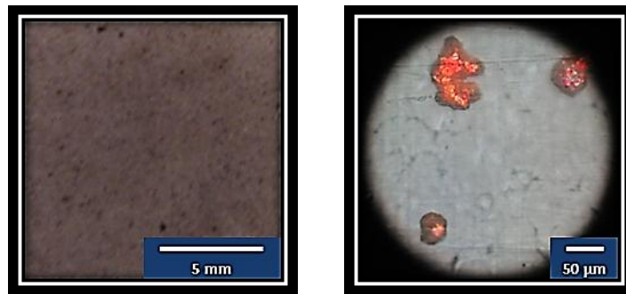
Figura 20. Imagen de la placa y micrografía del compuesto PP/Cu 5% p/p de Cu.
