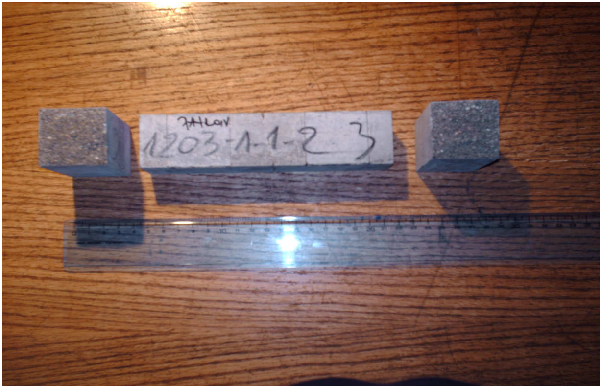
Imagen 5: Probetas ensayadas a resistencias mecánicas, Cemento Patrón.
