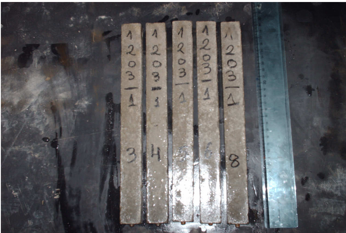
Imagen 10: Probetas cemento Patrón sumergidas en solución sulfatada durante 8 semanas.
