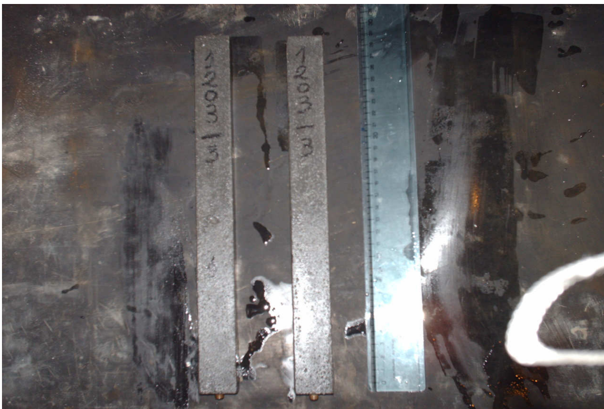
Imagen 8: Probetas dosificación P40 sumergidas en agua durante 8 semanas.
