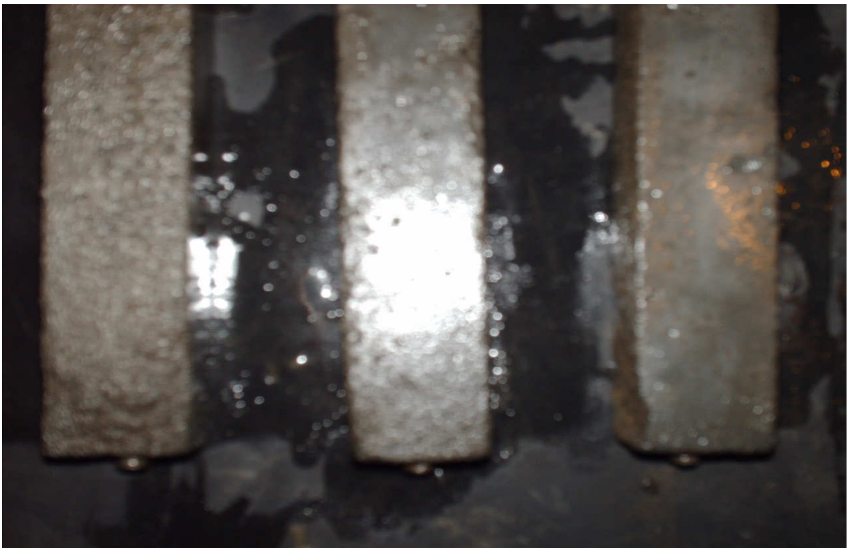
Imagen 11: Acercamiento probetas dosificación P40 sumergidas en solución sulfatada durante 8 semanas.
