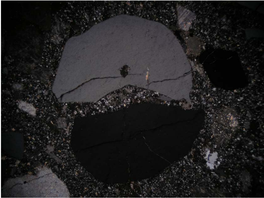
Microfotografía 3. Pórfido Microgranítico de biotita. Muestra 116854. Nícoles cruzados. Aumento 4 x 10. 4mm de campo visual en el largo. Cuarzo fracturado y levemente embahiado.
