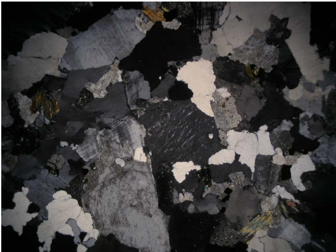
Microfotografía 8. Sienogranito de biotita. Muestra 116861. Nícoles cruzados. Aumento 4 x 10. 4mm de campo visual en el largo. Microclinas y Ortoclasa de textura perthítica.
