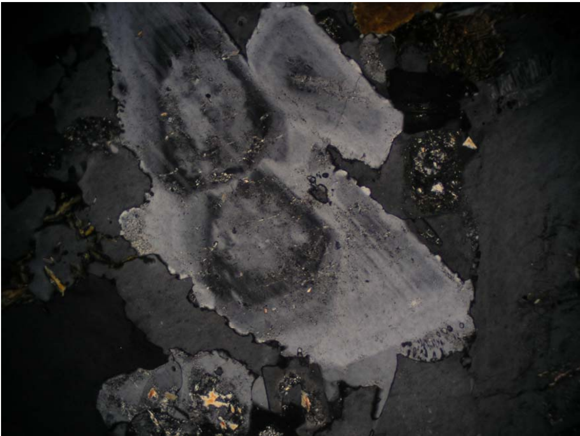
Microfotografía 14. Granodiorita de biotita. Muestra 118313. Nícoles cruzados. Aumento 4 x 10. 4mm de campo visual en el largo. Plagioclasas zonadas y reabsorvidas.
