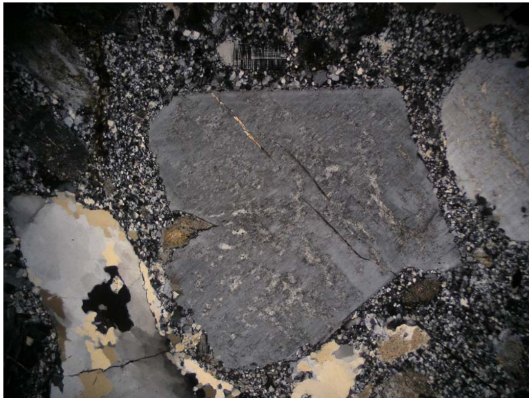
Microfotografía 2. Pórfido Microgranítico de biotita. Muestra 116838. Nícoles cruzados. Aumento 4 x 10. 4mm de campo visual en el largo. Microclina perfitica y cuarzo levemente deformado.
