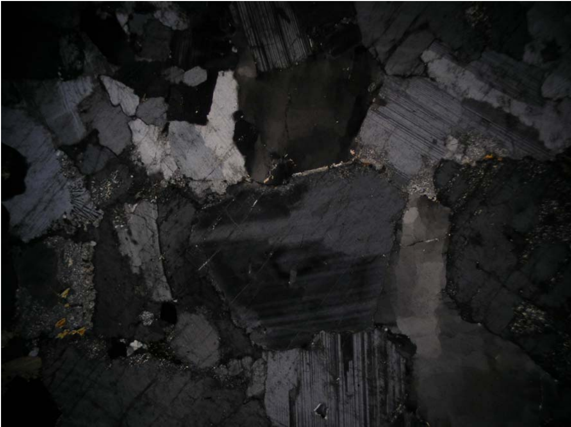
Microfotografía 10. Monzogranito de biotita y hornblenda. Muestra 116938. Nícoles cruzados. Aumento 4 x 10. 4mm de campo visual en el largo. Plagioclas zonada y cuarzo onduloso.
