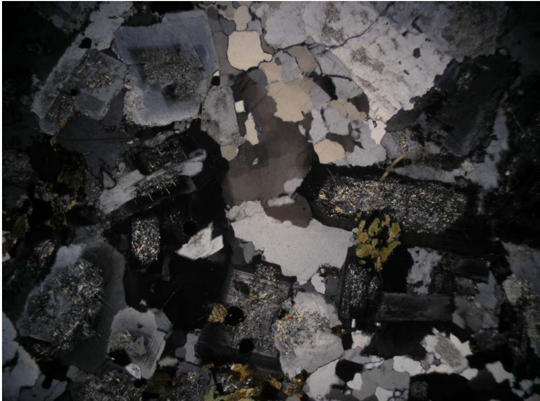
Microfotografía 12. Monzogranito de biotita. Muestra 116841. Nícoles cruzados. Aumento 4 x 10. 4mm de campo visual en el largo. Cuarzo de extinción ondulosa y plagioclasas zonadas con alteración sericítica concentrada en sus núcleos.
