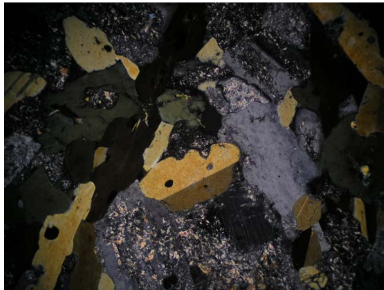
Microfotografía 16. Diorita de hornblenda como inclusión en Tonalita de biotita y hornblenda. Muestra 118319. Nícoles cruzados. Aumento 4x10. 4mm de campo visual en el largo.
