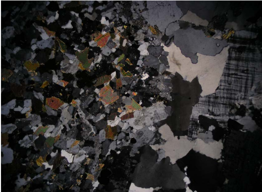
Microfotografía 7. Sienogranito de biotita. Muestra 116861. Nícoles cruzados. Aumento 4 x 10. 4mm de campo visual en el largo. Inclusión diorítica a la izquierda. Contacto con cuarzos de extinción ondulosa. Microclina a la derecha.
