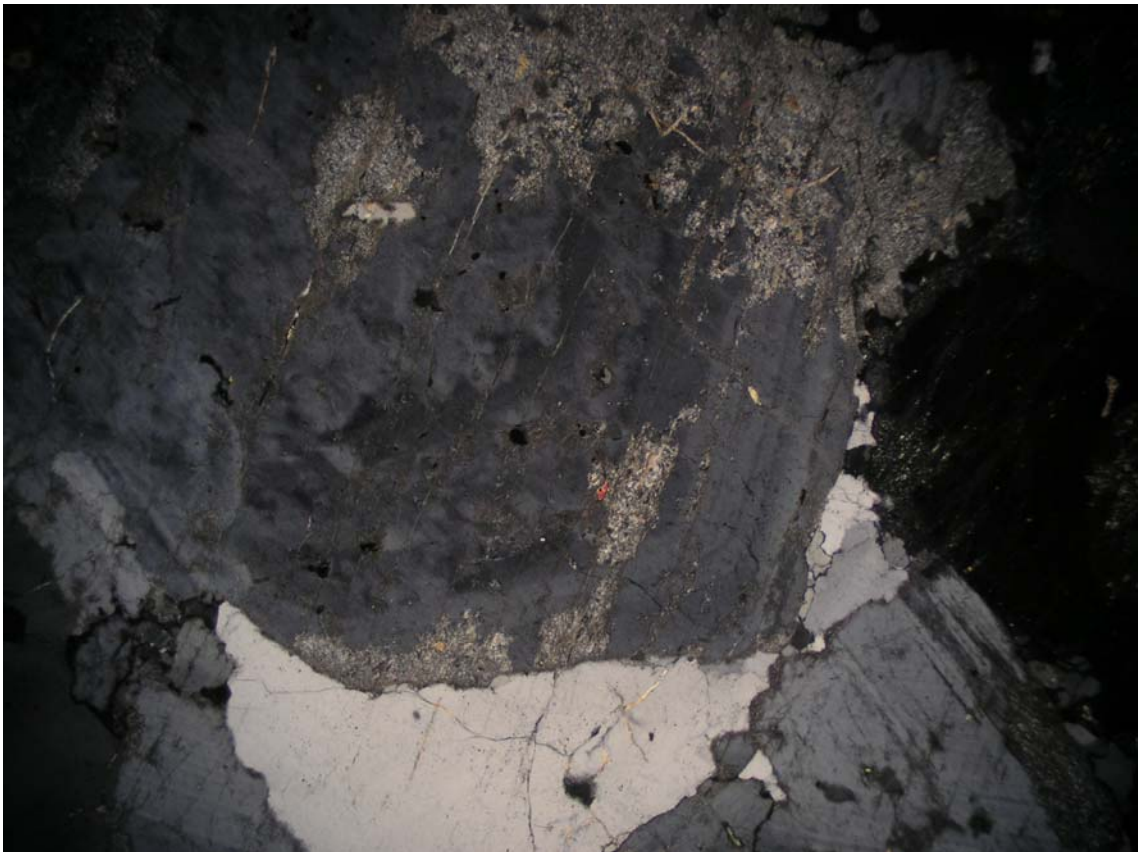
Microfotografía 9. Monzogranito de biotita y hornblenda. Muestra 116938. Nícoles cruzados. Aumento 4 x 10. 4mm de campo visual en el largo. Ortoclasa zonada.
