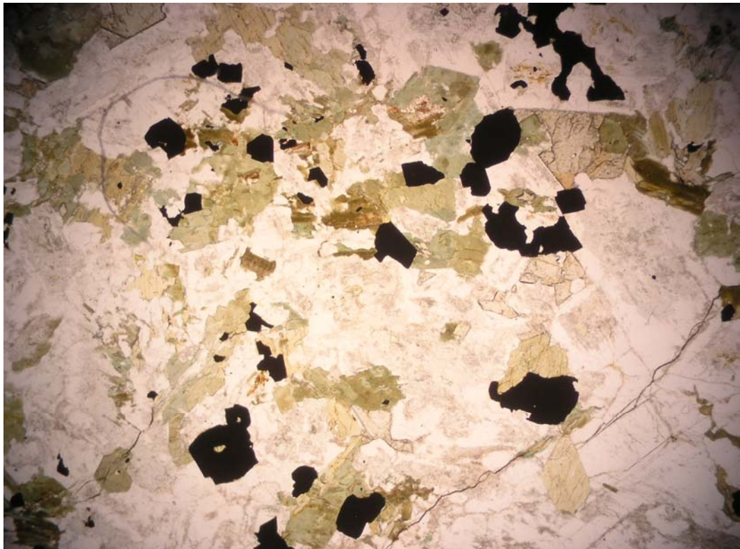
Microfotografía 13. Monzogranito de biotita. Muestra 116841. Nícoles paralelos. Aumento 4 x 10. 4mm de campo visual en el largo. Cúmulo de minerales máficos y opacos.
