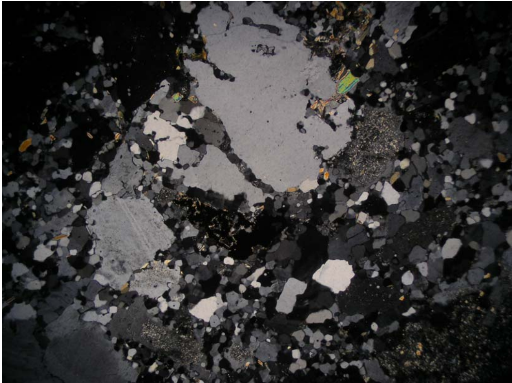
Microfotografía 5. Sienogranito porfídico de biotita. Muestra 116931. Nícoles cruzados. Aumento 4 x 10. 4mm de campo visual en el largo. Cuarzo embahiado.
