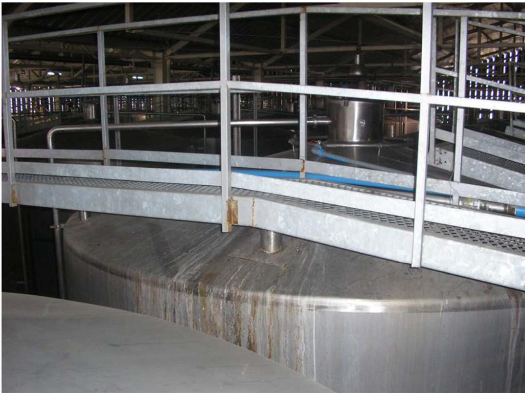
Figura 3.46: Cuba A133, estanque apoyado, pasarela sobre techo
