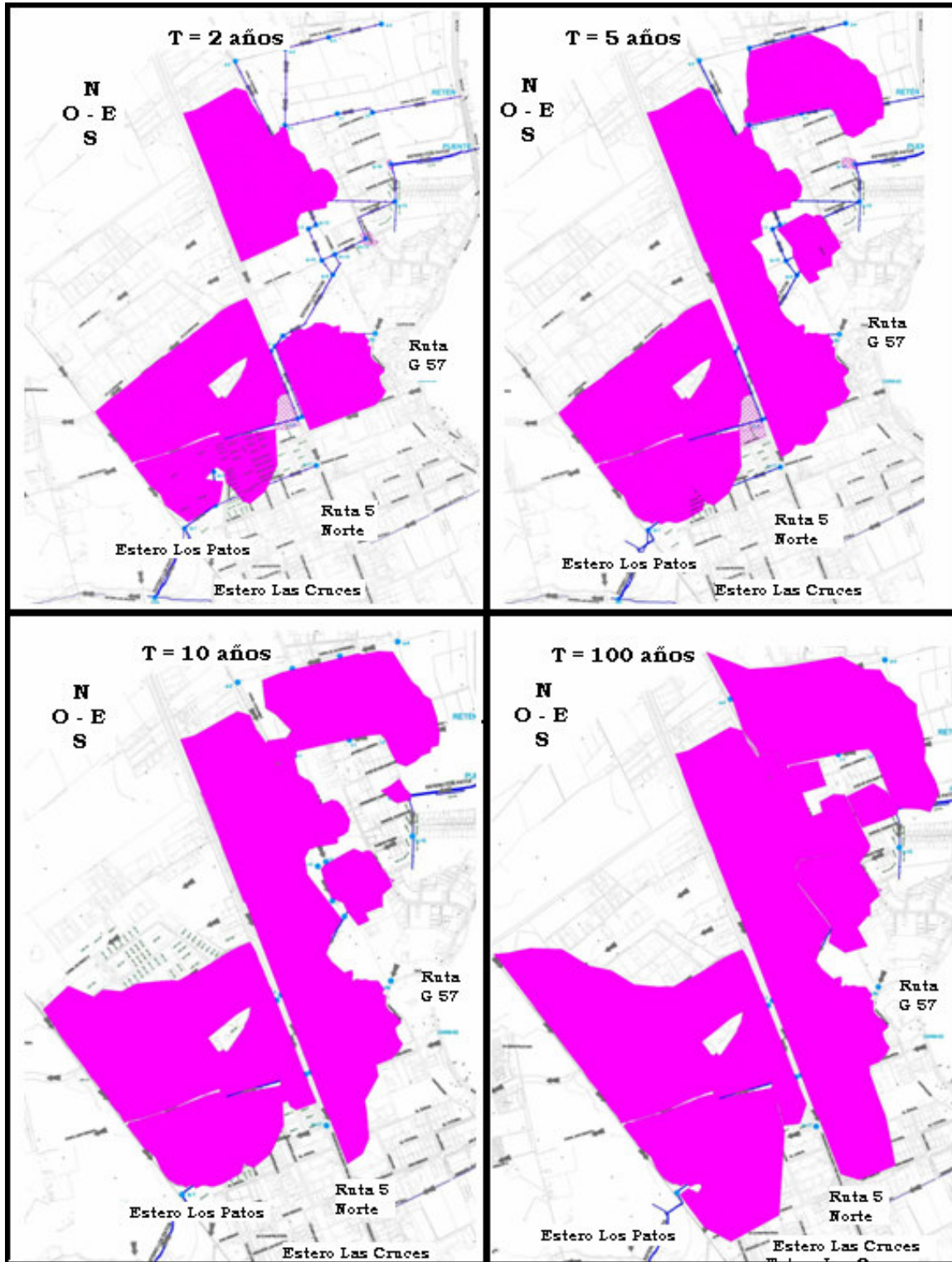
FIGURA 5.12 ÁREAS DE INUNDACIÓN PARA DISTINTOS PERÍODOS DE RETORNO EN ZONA BAJA.
