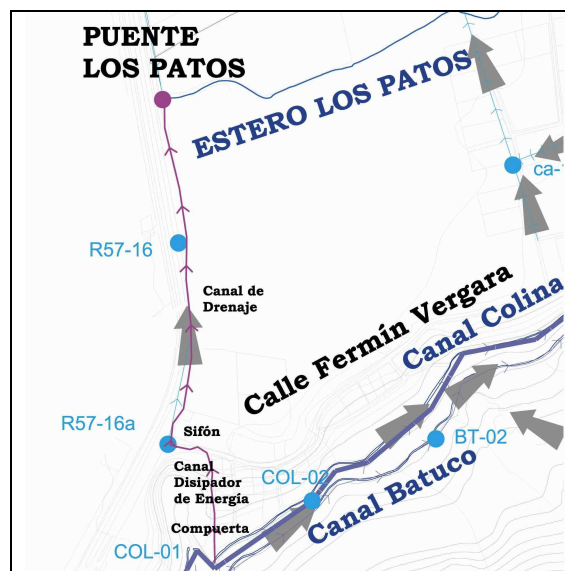
FIGURA 6.8 ESQUEMA DE OBRA DE SANEAMIENTO PARA SECTOR 2.
