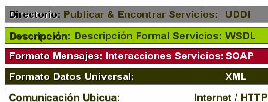
Figura 2 La pila de los Servicios Web
