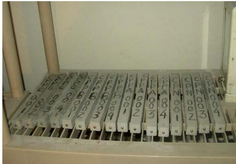
Figura 5.5 Probetas de retracción libre en la cámara seca.
