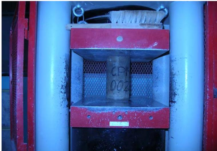
Figura 5.13 Ensayo de compresión de cilindros.
