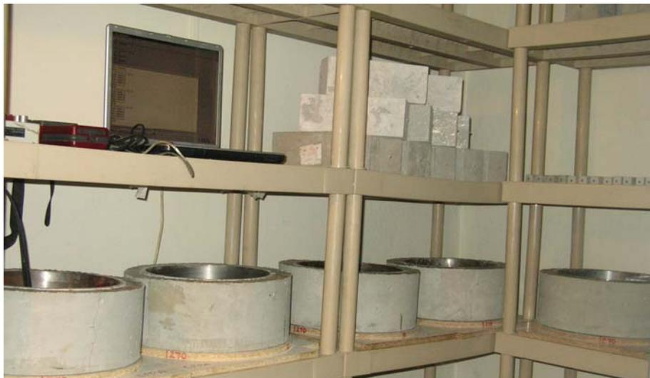
Figura 5.12 Vista de las probetas de retracción restringida.
