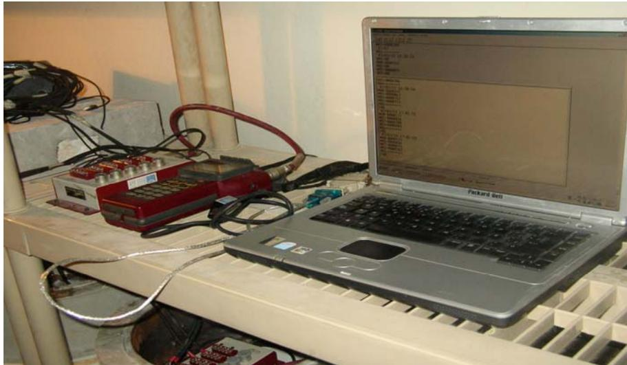
Figura 5.11 Adquisición de datos de ensayo de retracción restringida.
