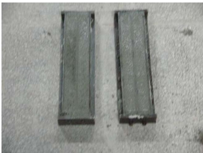
Figura 5.2 Probetas de retracción libre.
