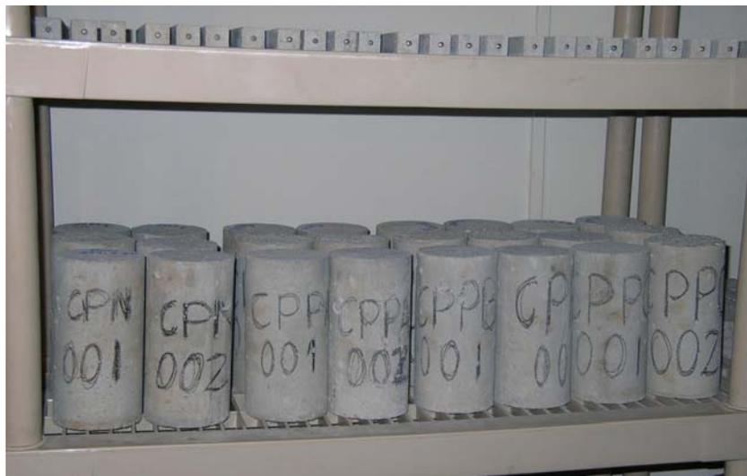
Figura 5.7 Probetas cilíndricas en la cámara seca.
