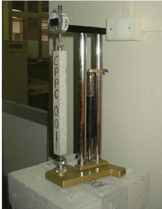
Figura 5.10 Medición de probetas de retracción libre.
