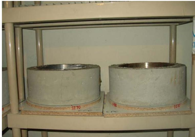
Figura 5.6 Probetas de retracción restringida en la cámara seca.
