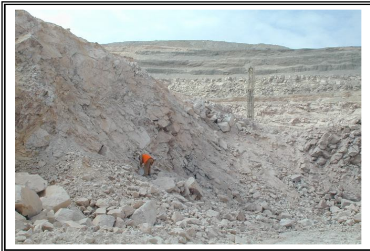
Figura 4.7: Ejemplo de toma de muestras de carga puntual en terreno.
