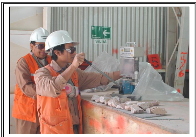
Figura 4.8: Ensayo carga puntual de muestras de terreno.
