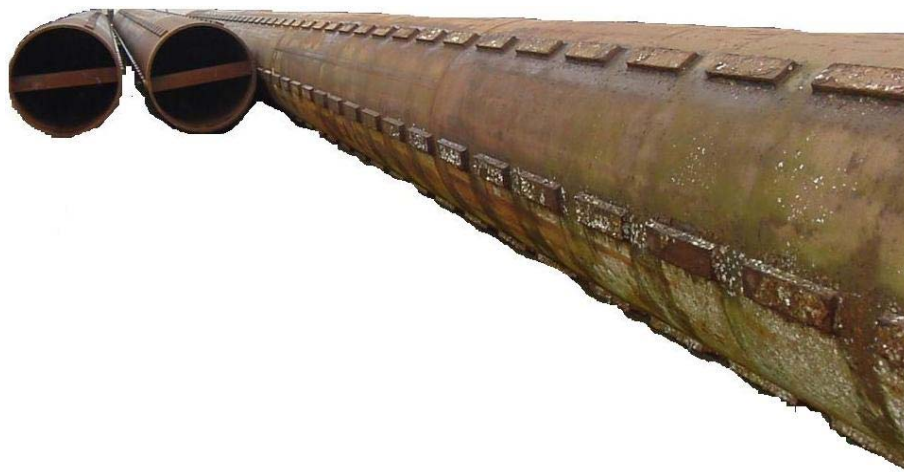
Figura 3.3: Columna típica de una plataforma Jack Up
