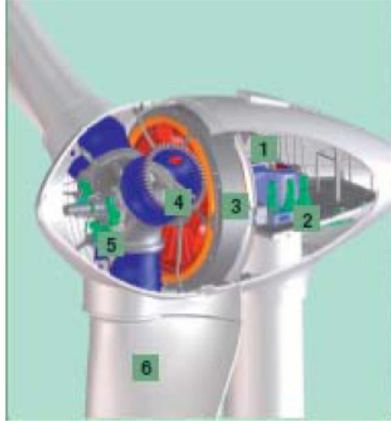
Figura 3.16: Turbina Enercon E-70: 1. Guía principal, 2. Motores de viraje, 3. Generador anular, 4. Adaptador de álabes, 5. Centro del rotor, 6. Álabe del rotor.
