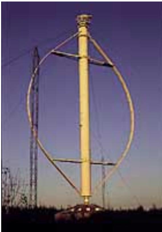
Figura 3.10: Eole C, un aerogenerador de eje vertical Darrieus de 4200 kW, con un diámetro de rotor de 100 m, en Cap Chat, Québec (Canadá). Esta máquina, que es el aerogenerador más grande del mundo, ya no está operacional.
