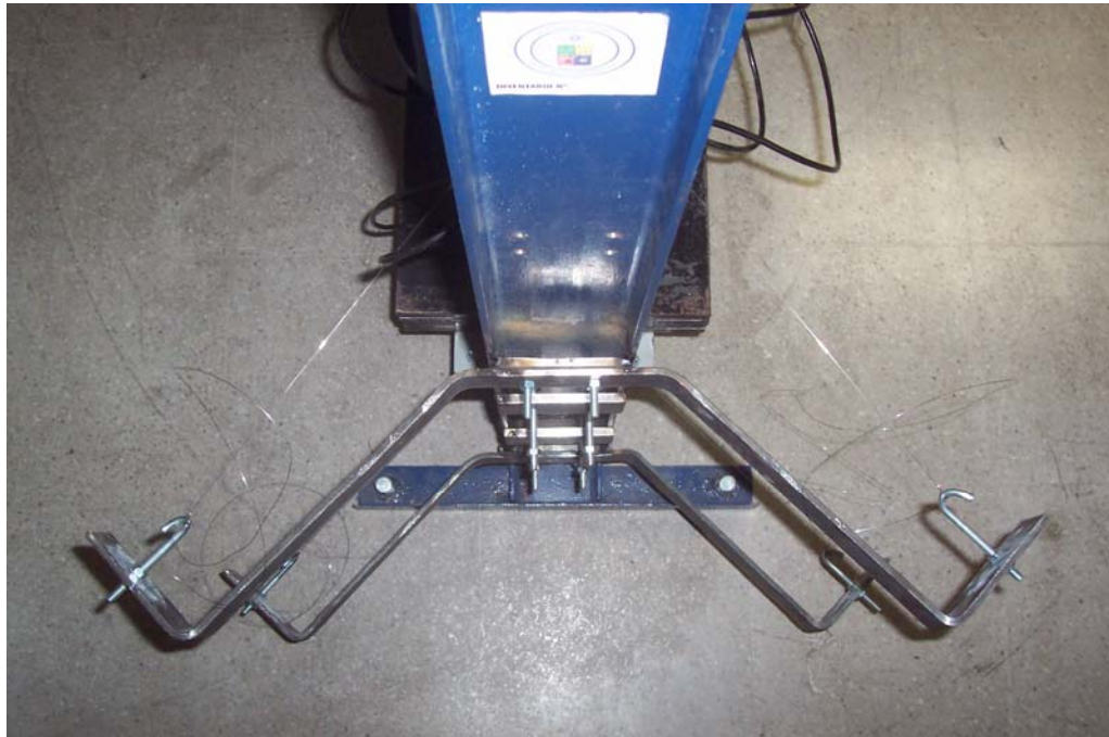
Figura 3.6: TMD, configuración final, vista en planta
