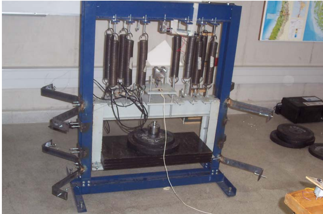
Figura 3.5: TMD, configuración final
