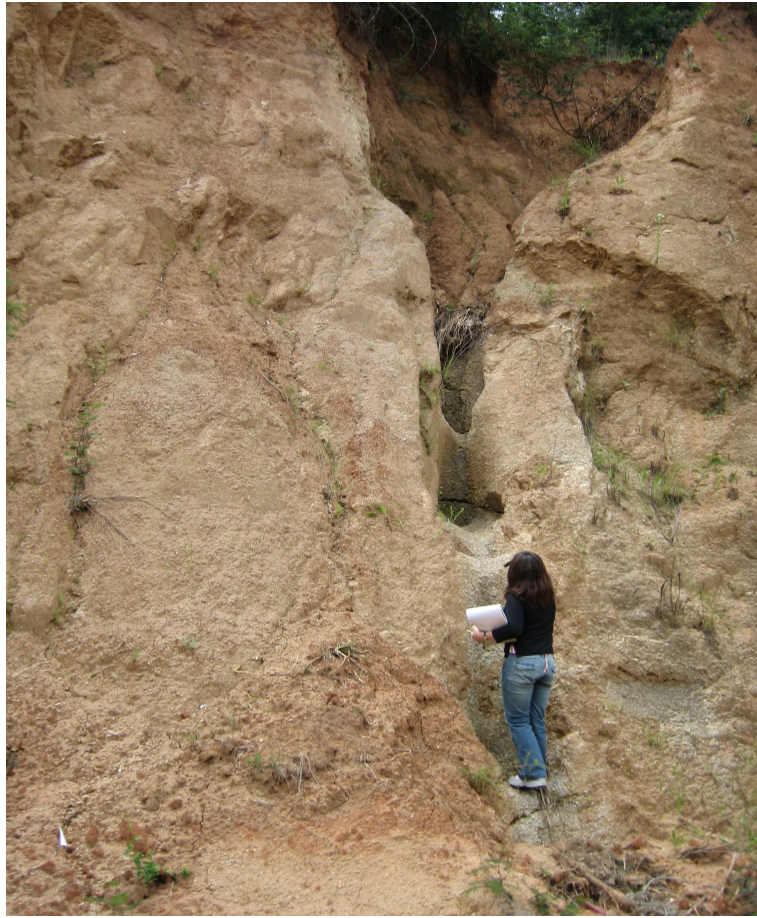
Fig 35 “Km 98.300 detalle de una de las fallas en este kilometraje”
