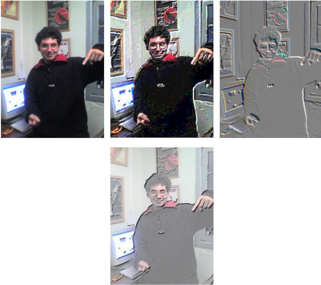
Imagen 31: Izquierda: Imagen original. Centro arriba: Repujado. Derecha: Paint Shop Pro (Emboss). Abajo: Paint Shop Pro (Black Pencil/Medium Pencil)
