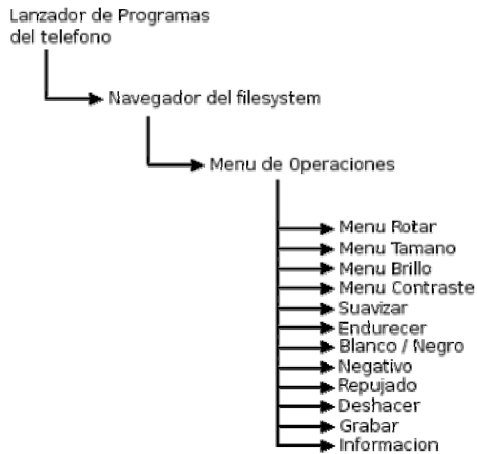
Diagrama 1: Estructura de menús de la aplicación
