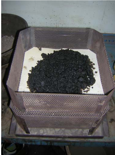
Figura 4.1-d; Disposición de las probetas disgregadas para envejecer aceleradamente en el calcinador
