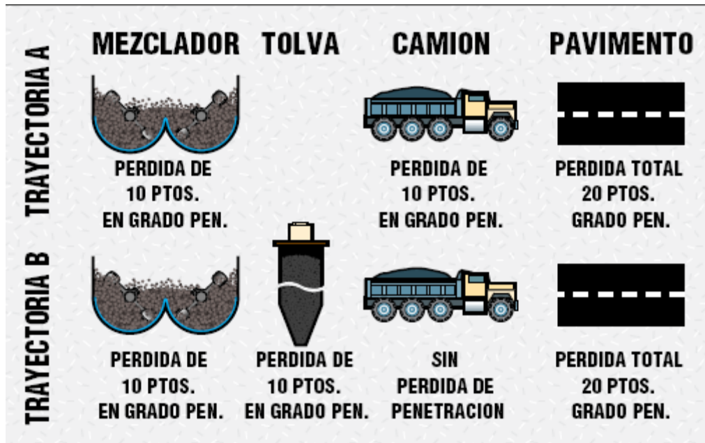
Figura 1.1-e; pérdida de penetración de la mezcla desde el mezclado hasta la puesta en obra. Fuente ASTEC
