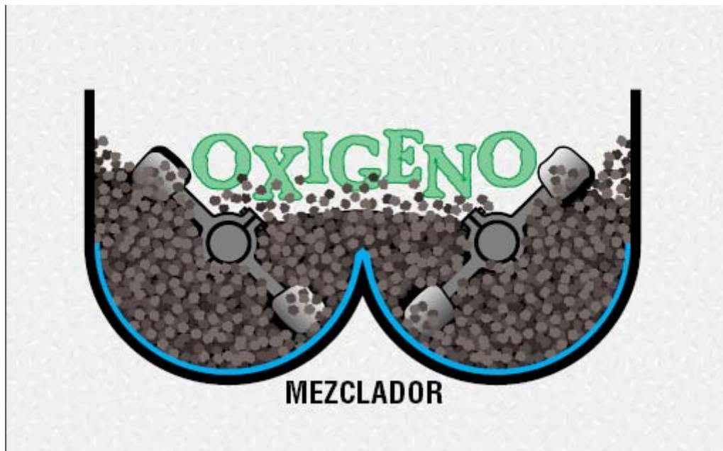
Figura 1.1-a; oxidación durante la etapa de mezclado. Fuente ASTEC
