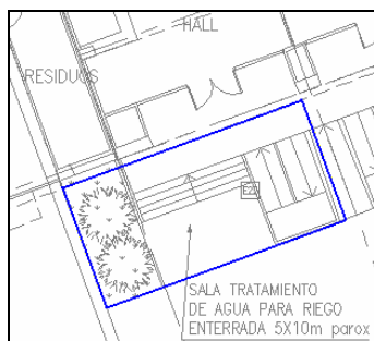
Figura 6.1: Ubicación Sistema de Tratamiento Aguas Grises
