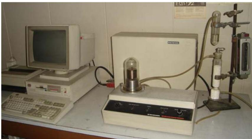
Figura 2.4: Calorímetro Du Pont 2000 [11,18].
