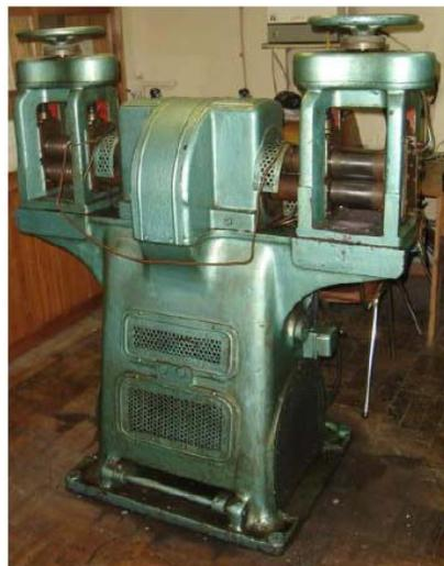
Figura 2.7: Laminadora para deformaciones en frío [11].
