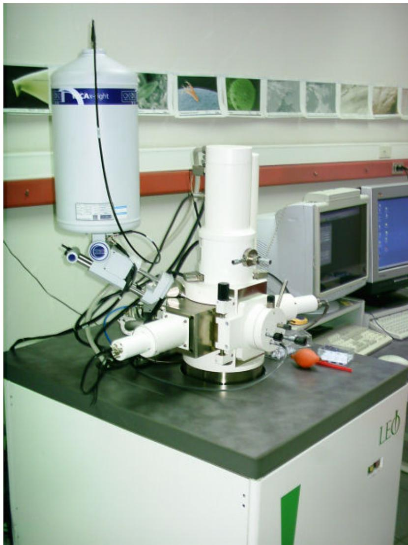
Figura 2.10: Microscopio Electrónico de Barrido LEO 1420VP.
