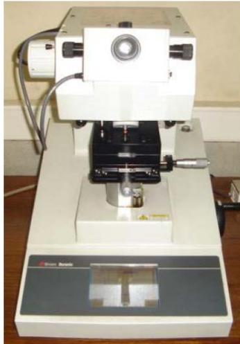
Figura 2.6: Microdurómetro Struers Duramin [11].
