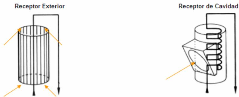
De acuerdo al mecanismo de transferencia de calor, se puede distinguir dos tipos de receptores; de absorción directa y de absorción indirecta. En cuanto al fluido de trabajo se han propuesto diferentes medios al cual transferir el calor recibido, ya sea agua, aire, sales fundidas, sodio fundido, partículas sólidas, etc.
