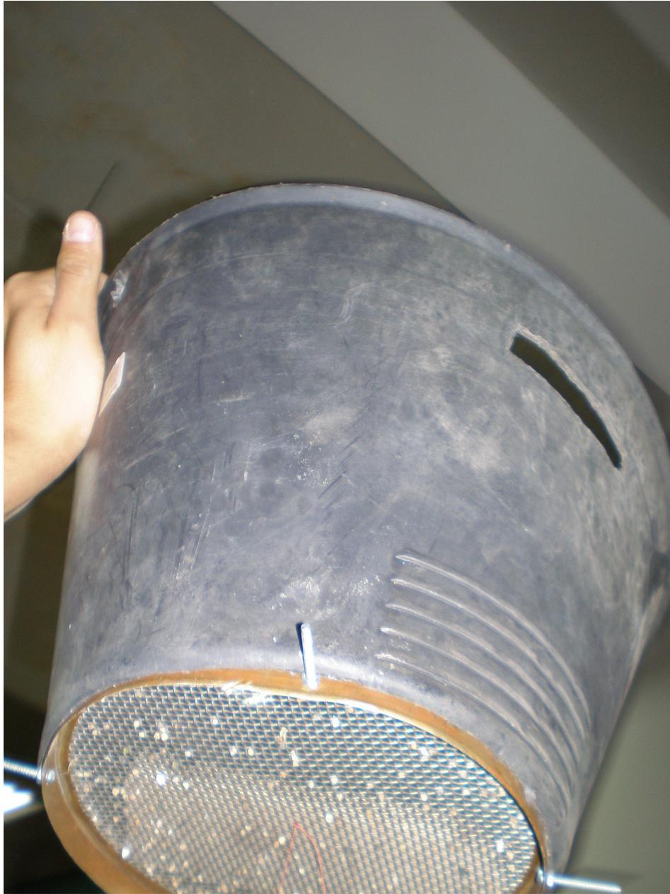
Fig. 4-4 Balde de descarga con malla ASTM#10
