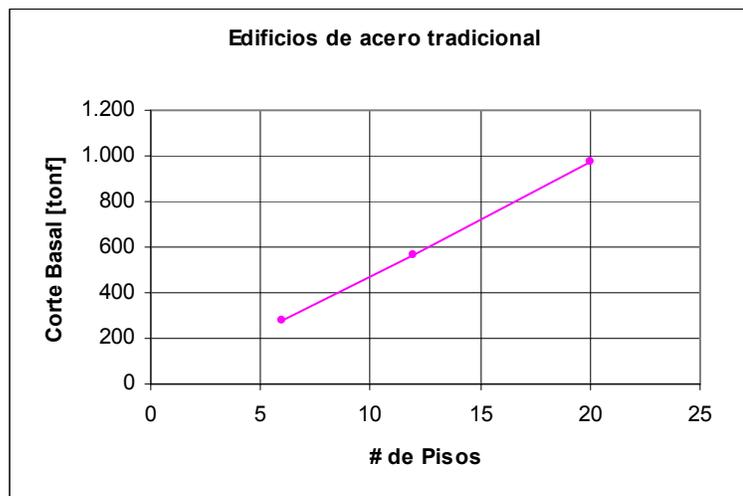
Figura 3.23: Corte Basal edificios de acero tradicional
